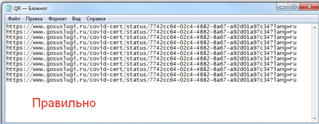
Если при считывании в Блокнот теряются символы, строка считывается не полностью, несколько попыток чтения одного и того же QR кода дают разный результат и т.п, то необходимо при помощи настройки сканера уменьшить скорость считывания в режиме эмуляции клавиатуры. Как именно это делается - зависит от конкретной модели сканера.
