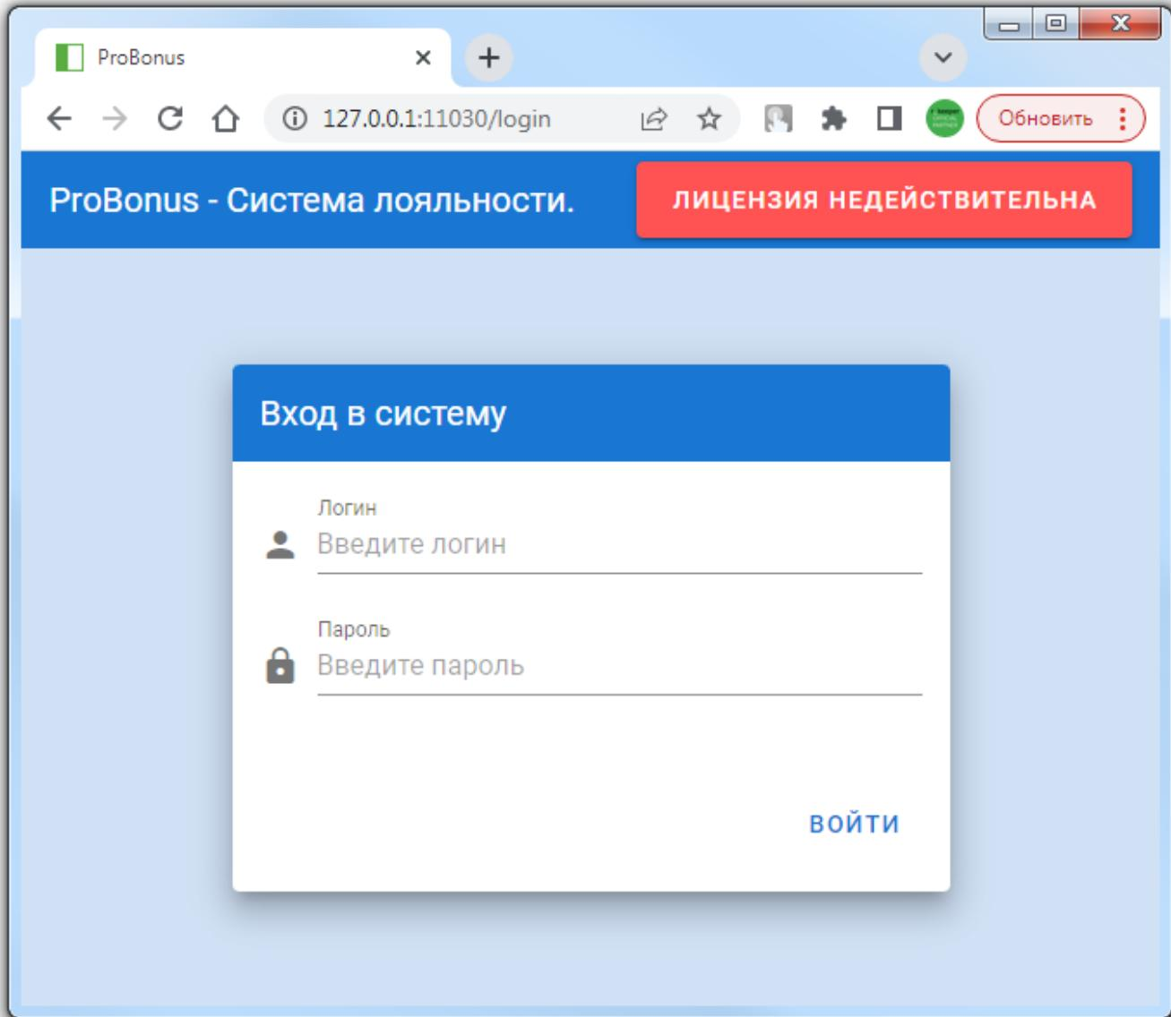
После проверки можно завершить работу нажатием кнопки “Закрыть приложение”. В папке с модулем появится файл **config.json** - это файл конфигурации (настроек) модуля. Если порт используемый по умолчанию (11030) занят, то его можно изменить в данном файле (параметр app→port).
