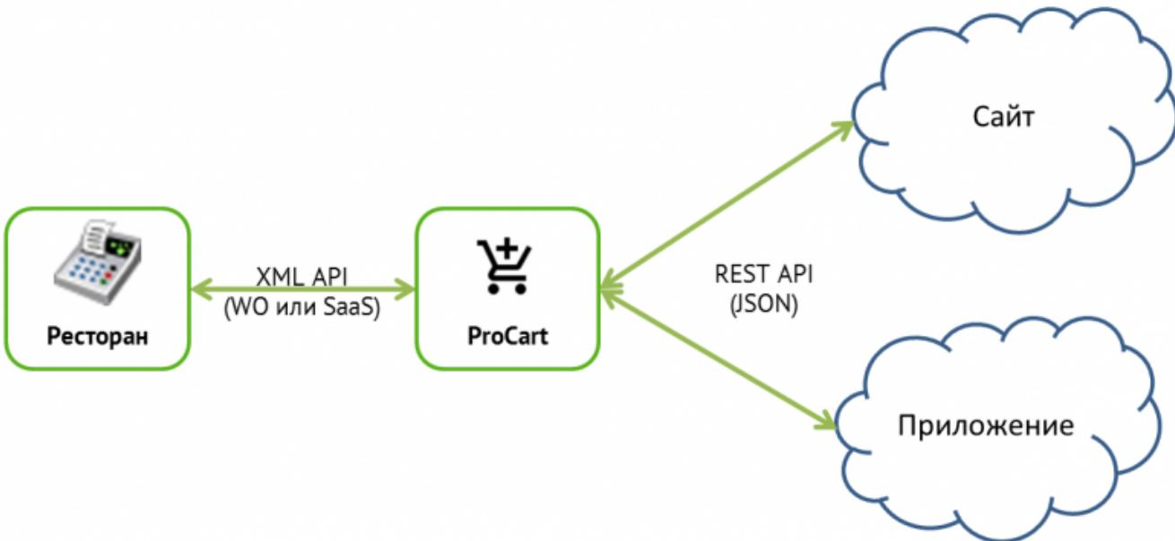
ProCart обеспечивает работу с системой **r\_keeper** через Rest API (json). Для получения запросов из внешней системы в ресторане должен быть «белый» IP, а так же необходимо будет пробросить порт.
