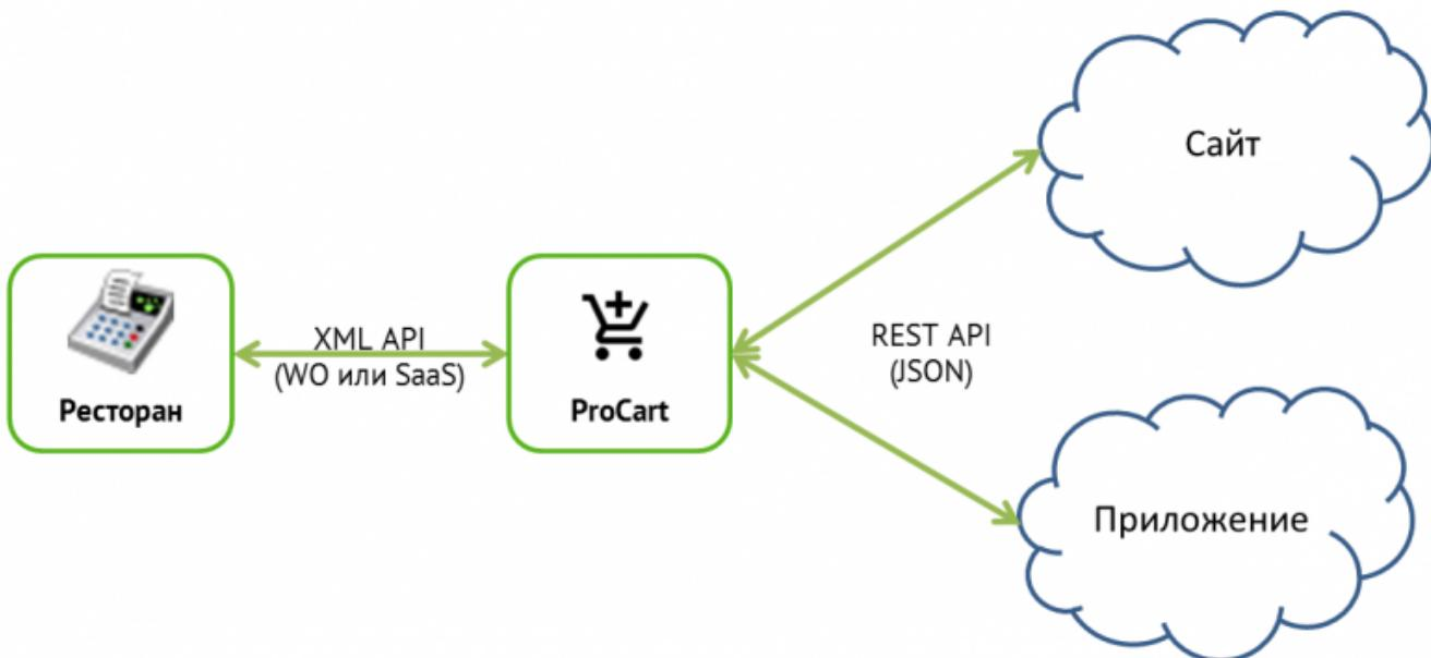
ProCart обеспечивает работу с системой **r\_keeper** через Rest API (json). Для получения запросов из внешней системы в ресторане должен быть «белый» IP, а так же необходимо будет пробросить порт.
