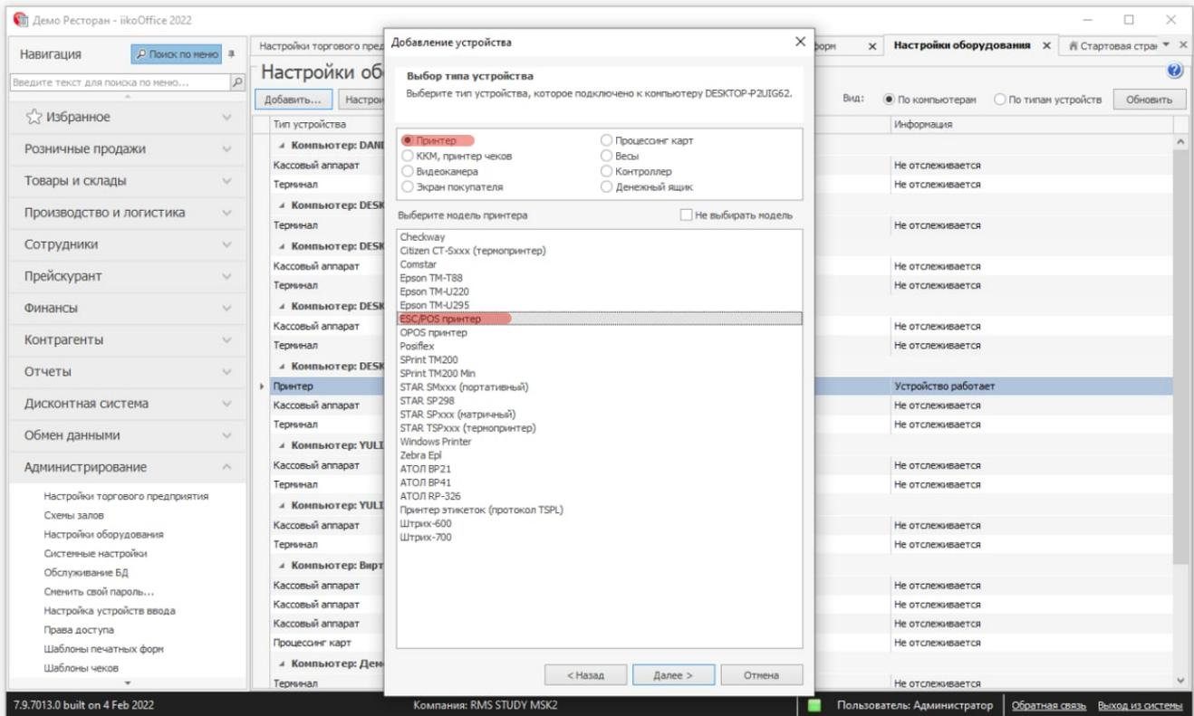
Заполнить параметры нового устройства следующим образом **Название** - дать осмысленное название принтеру, соответствующее потоку сервис-печати **Подключение** - TCP/IP **Номер порта** - Порт, который были определен для данного потока на этапе [настройки службы ProKMS](#). **Адрес** - IP адрес компьютера на котором установлена служба ProKMS **Кодовая страница** - Windows-1251 Остальные параметры оставить по умолчанию.
